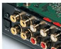
Mirror Media® MM-1と他社製デジタルオーディオ機器が接続できる2系統のデジタル入力端子、接続機器に合わせてアサイン可能なアナログ音声6入力/6出力などの豊富な入出力端子を装備。また、映像2系統入出力(バックカメラ専用入力含む)を装備し、カーナビや地デジチューナー、DVDプレーヤーなどからの映像信号に、本機からの文字情報を重ねて外部ディスプレイなどに出力できるOSD(オンスクリーンディスプレイ)対応の映像回路を内蔵。リアビューカメラの映像を後退時に自動選択するリバースギヤにも連動します。
